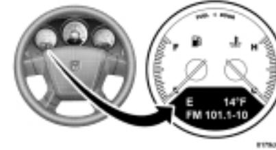
Elektronik Araç Bilgi Merkezi (EVIC) etkileşimli bir ekrana sahiptir. Gösterge grubunun alt kısmında, yakıt göstergesi ile motor soğutma sıvısı hararet göstergesi arasında yer almaktadır. EVIC aşağıda belirtilen işlevlerden oluşmaktadır:
