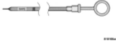
Motor yağı seviyesi kontrol çubuğu
